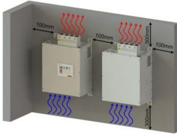
Şekil 2: SVG duvar tipi cihazın konumlandırılması
