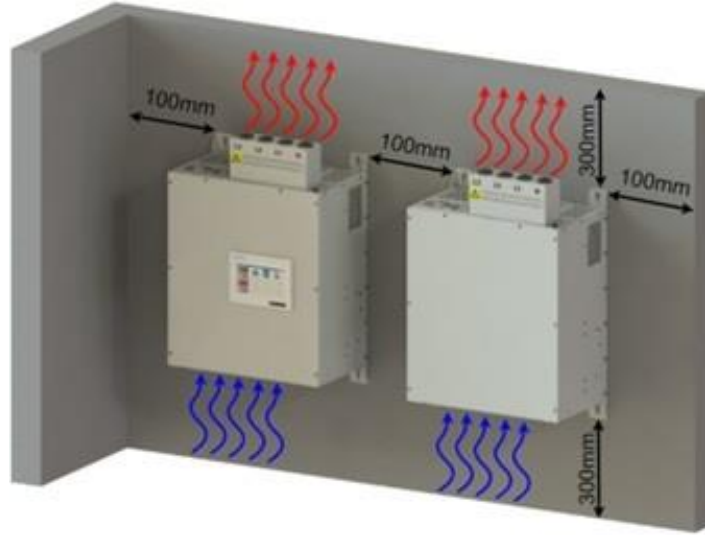
Şekil 2: AHF duvar tipi cihazın konumlandırılması
