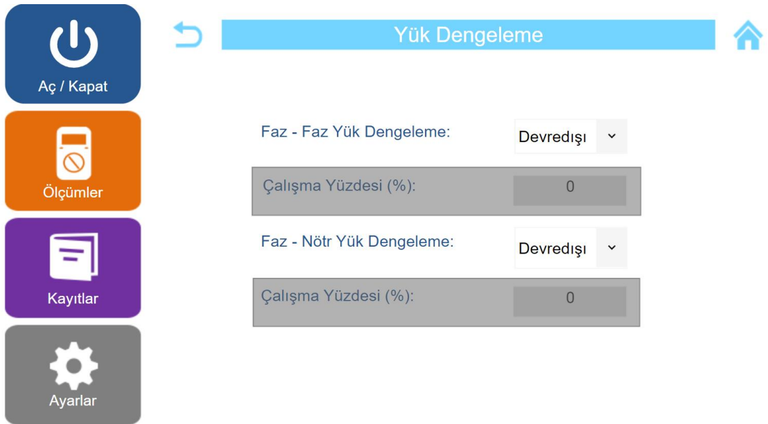
Şekil 38: “Yük Dengeleme” verilerinin sıfırlanması
